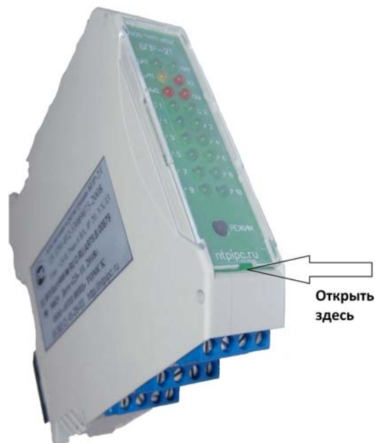
Рисунок 5 – Снятие прозрачного стекла передней панели БПР
